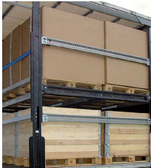
CTD III – podepření nosníku
